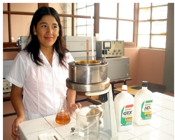
Figura 2. Instrumentos y materiales para la medición de la viscosidad en grados Engler.
